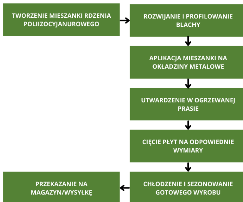
Rysunek 5.2: Schemat procesu produkcyjnego płyt warstwowych z trójwarstwowym rdzeniem PIR
